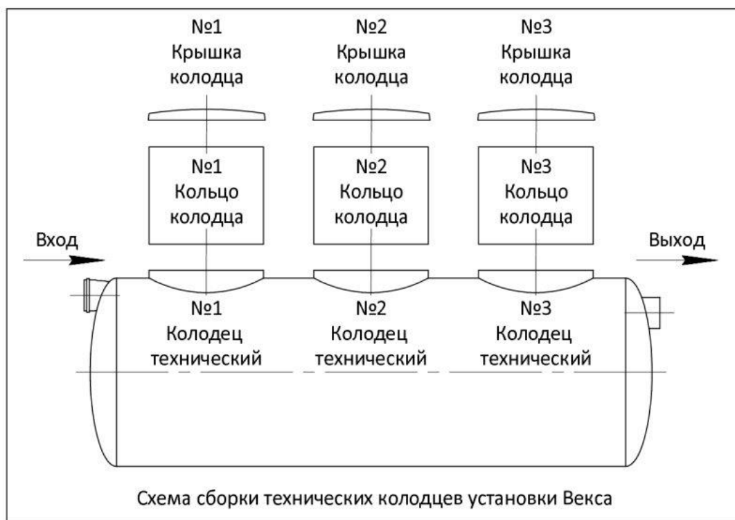
Рисунок 6 – Схема сборки
